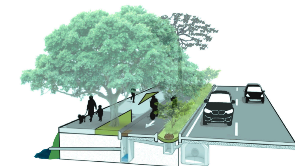
Corte esquemático com jardins de chuva, sistema de drenagem e estrutura viária.
